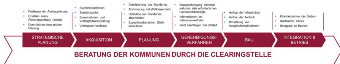
Abbildung 1: Phasen und Aufgaben im Realisierungsprozess eines Mobilfunkstandorts
